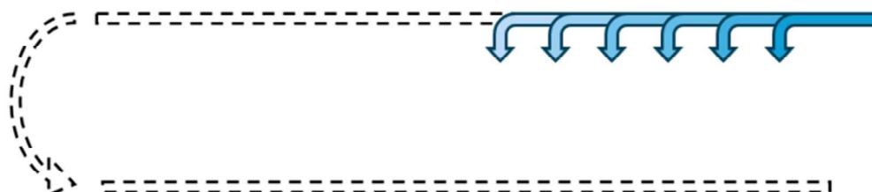
Schéma de principe de l'injection de l'air directement par les buses du canal aller.
